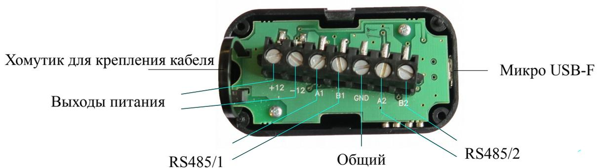
Рис. 1. Вид со снятой крышкой. Назначение соединителей
