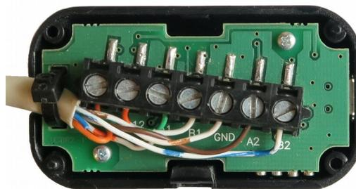
Рис. 2. Вид со снятой крышкой. Крепление кабеля
