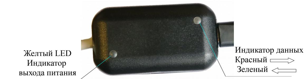
Рис. 3. Конвертер в сборе
